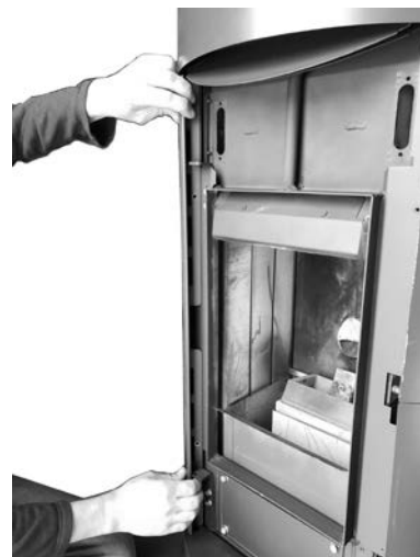
Fig. 66 - Verwijdering voorste profielen (rechts en links).
