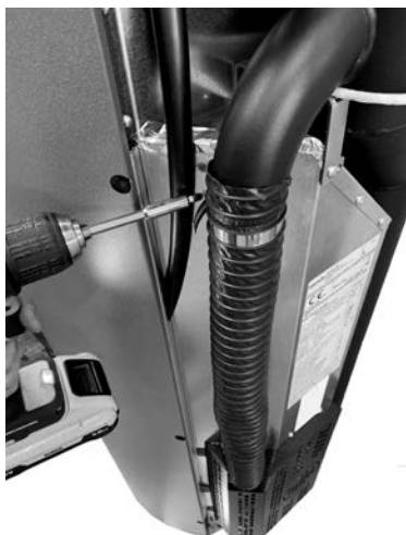
Fig. 83 - Extraire le tuyau flexible
