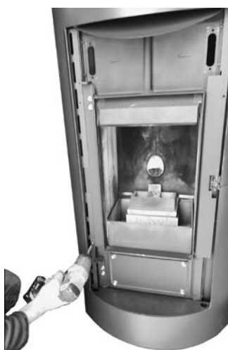
Fig. 70 - Retrait des vis et des profils (droit et gauche)
