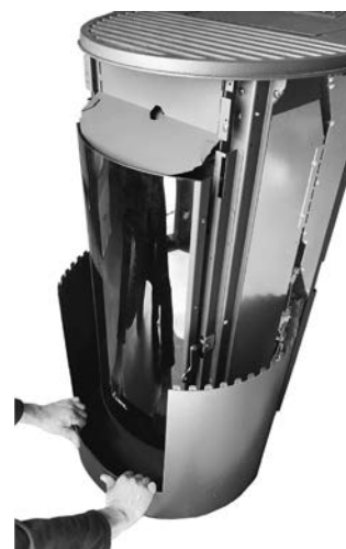
Fig. 74 - Extraire la coque inférieure en tirant vers soi.
