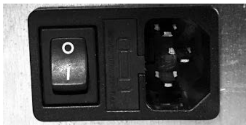
Fig. 75 - Presa elettrica con interruttore generale
