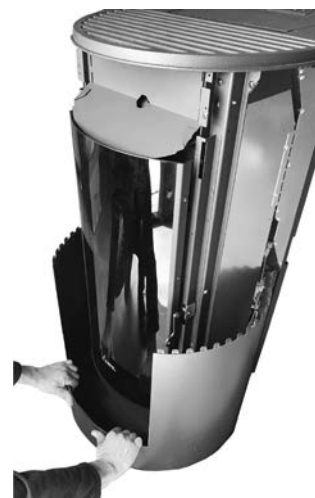
Fig. 69 - Sfilare il guscio inferiore tirando verso di sé.
