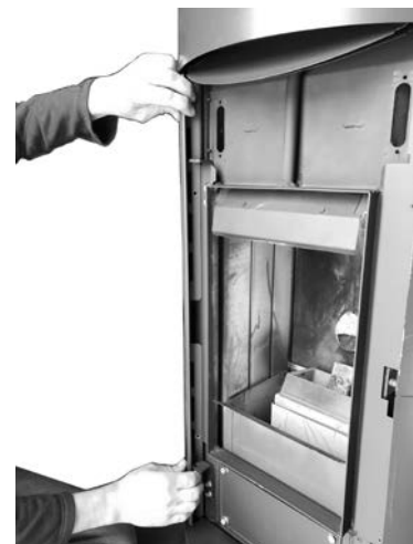
Fig. 66 - Rimozione profili anteriori (dx e sx).
